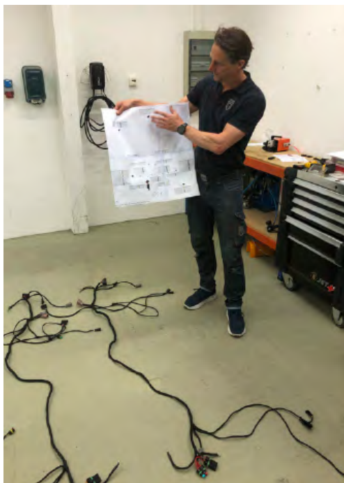
Martin förevisar ett kopplingschema med det egentillverkade kablaget. Foto: Sören Wictorsson.
