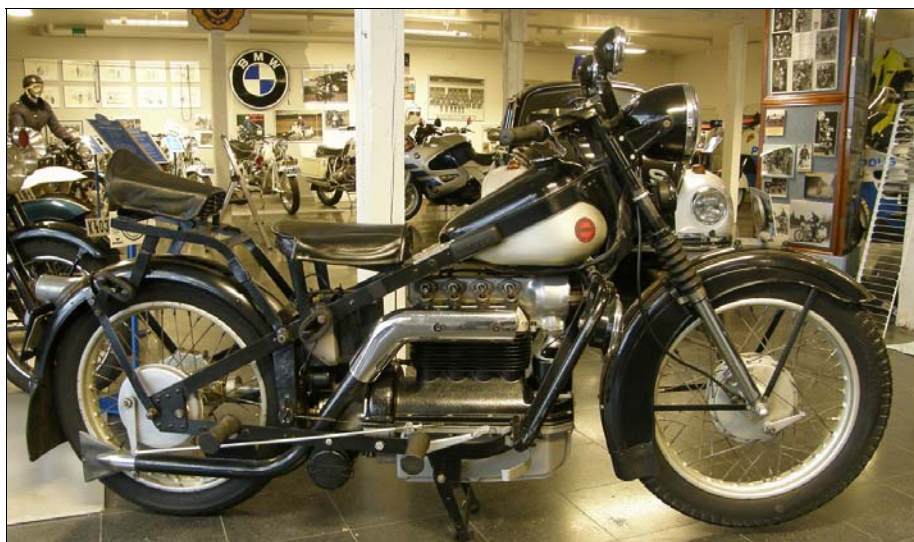
Polisnimbussen framrullad för fotografering. Passagerarsadeln är inte original och sadelstativet har tidigare burit packväskor och kanske radion.
