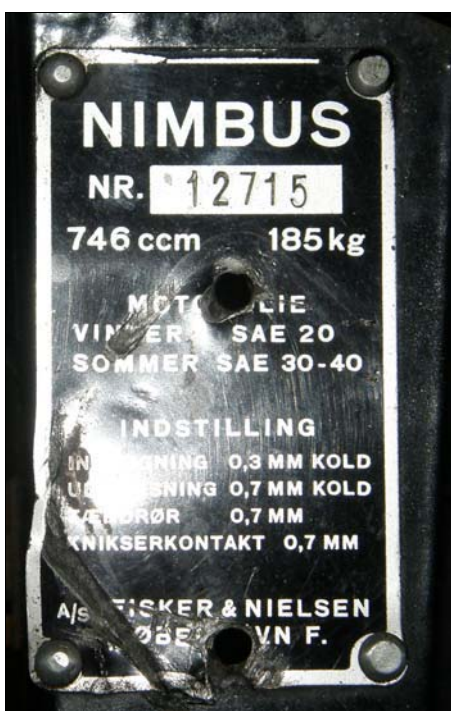
Dataskylten har två borrarade hål och spår av att något, kanske en kontakt, suttit här.
